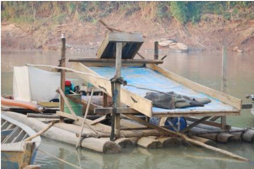
Fotografía 2. Draga de extracción de oro en el río Tambopata.
